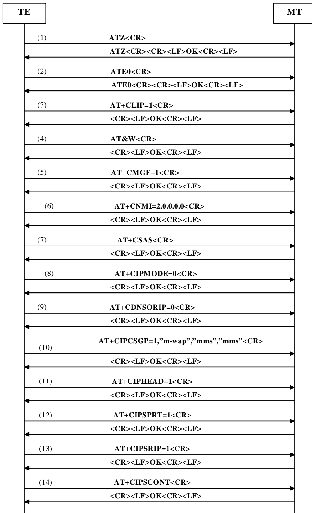
Hình 6: Khởi tạo cấu hình mặc định cho module SIM508.
